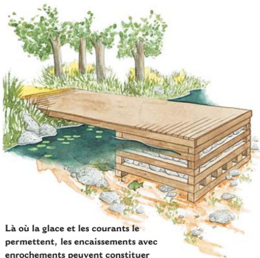
**Là où la glace et les courants le permettent, les encaissements avec enrochements peuvent constituer une fondation solide de quai.**
